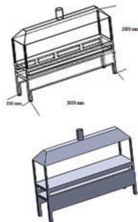
Туннельная печь с металлическим подом
